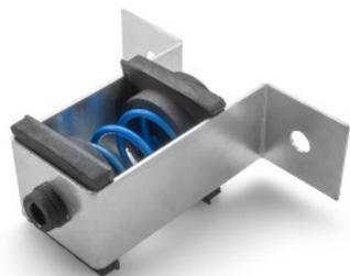
Gama diseñada para la suspensión de falsos techos acústicos y maquinaria trabajando a partir de 450 r.p.m. Fabricado con muelle calidad cola de piano de gran resistencia mecánica, guiado por dos placas de caucho y con tope fin de carrera interior para evitar la posibilidad de contacto entre espiras, en caso de sobrecarga.
