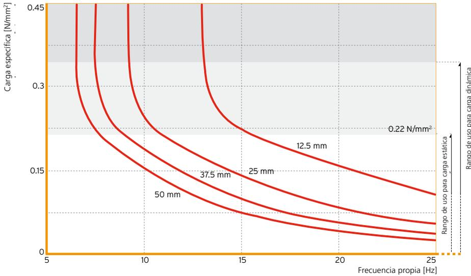
Figura 3: Frecuencia propia de un sistema simple de un grado de libertad que consiste en una masa fija conectada a un elemento elástico (Sylomer® SR 220) sobre un soporte rígido.
