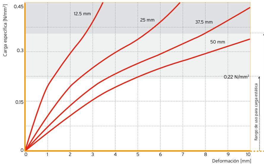
Figura 1: Curva de carga flecha cuasiestática a una velocidad de ensayo de 0.022 N/mm<sup>2</sup>/s
