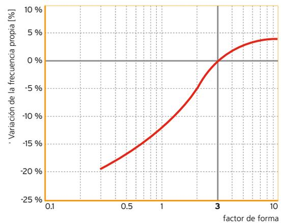
\*Valor de referencia: carga específica 0.22 N/mm<sup>2</sup>, factor de forma =3
