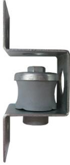
Gama diseñada para la suspensión de falsos techos acústicos y maquinaria trabajando a partir de 1.000 r.p.m. En toda la gama Akustik se mantiene el mismo elemento antivibratorio fabricado en caucho de gran calidad mecánica, especialmente diseñado para el aislamiento vibratorio. La estructura metálica es resistente a más de 650 kg y recubierta de baño electrolítico bicromatado.
