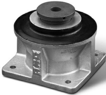
El soporte AMC-Mecanocaucho® cono con Base de Fijación, trabaja el elastómero a compresión cizalladura. Está constituido por una armadura exterior metálica de alta resistencia y de una armadura cónica interna que incorpora un nivelador para la correcta alineación del conjunto suspendido.
