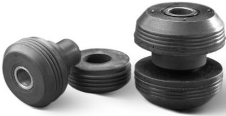
Los soportes antivibratorios AMC-Mecanocaucho® tipo SCH, son soportes compuestos por dos piezas de caucho, una de las cuales lleva un casquillo metálico interior que sirve de guía a través del tornillo de amarre al soporte de la máquina. Se instala precomprimido sobre el propio bastidor de la máquina, cuyo espesor "E" determina el grado de precompresión del mismo
