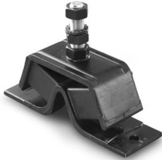
El soporte AMC-Mecanocaucho® Marino en V, trabaja el elastómero a compresión cizalladura. Está compuesto de 2 partes metálicas que permiten una instalación por medio de un tornillo en su parte superior y por dos agujeros de fijación al chasis.
