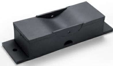
El Soporte transformador AMC-MECANOCAUCHO® es un muelle de caucho-metal especialmente diseñado para el soporte de las ruedas de un transformador.
