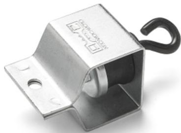
Gama diseñada para la suspensión de falsos techos acústicos y maquinaria trabajando a partir de 1.000 r.p.m. En toda la gama Akustik se mantiene el mismo elemento antivibratorio fabricado en caucho de gran calidad mecánica, especialmente diseñado para el aislamiento vibratorio. La estructura metálica es resistente a más de 650 kg y recubierta de baño electrolítico bicromatado.
