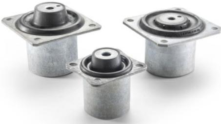
El CONO HIDRÁULICO AMC-MECANOCAUCHO es una combinación de un componente de muelle y un amortiguador hidráulico en la forma de un cono. Ambos componentes pueden ajustarse entre sí. Para un buen aislamiento de vibraciones, se necesita un coeficiente de amortiguación bajo pero para el control de movimiento se requiere de un alto coeficiente de amortiguación. El CONO HIDRÁULICO AMC MECANOCAUCHO combina estos dos requisitos completamente diferentes en un solo soporte.
