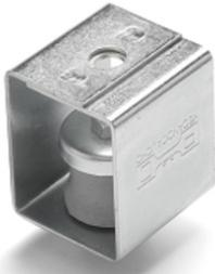
Gama diseñada para la suspensión de falsos techos acústicos y maquinaria trabajando a partir de 1.000 r.p.m. En toda la gama Akustik se mantiene el mismo elemento antivibratorio fabricado en caucho de gran calidad mecánica, especialmente diseñado para el aislamiento vibratorio. La estructura metálica es resistente a más de 650 kg y recubierta de baño electrolítico bicromatado.
