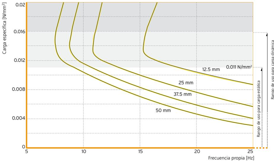
Figura 3: Frecuencia propia de un sistema simple de un grado de libertad que consiste en una masa fija conectada a un elemento elástico (Sylomer® SR 11) sobre un soporte rígido.
