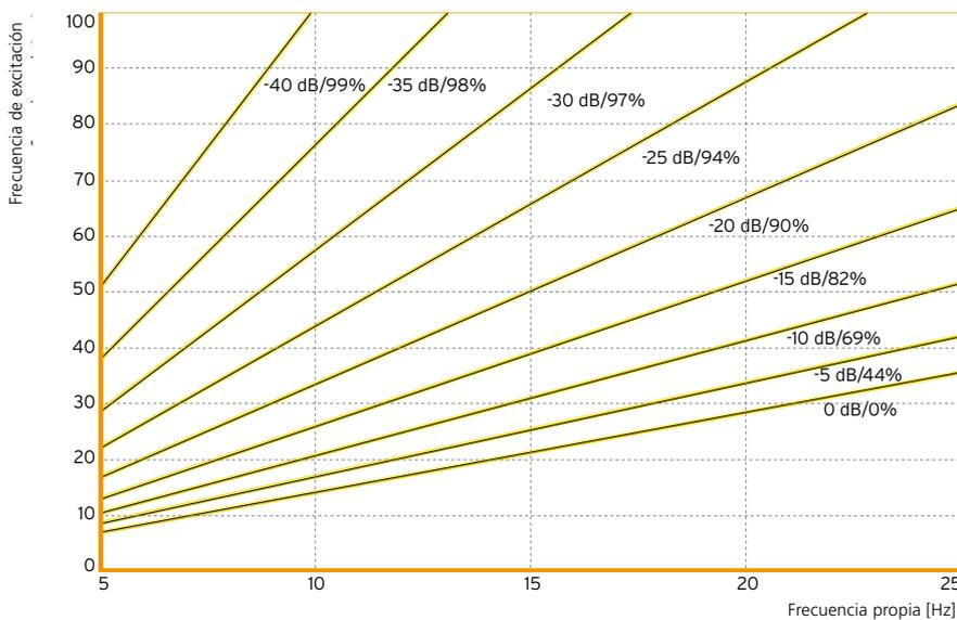
Figura 4: Reducción de la transmisión de las vibraciones mecánicas mediante la instalación del material elástico Sylomer® SR 11.
