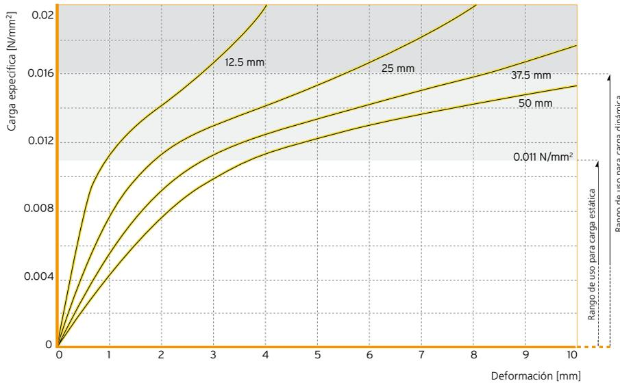
Figura 1: Curva de carga flecha cuasiestática a una velocidad de ensayo de 0.0011 N/mm2/s
