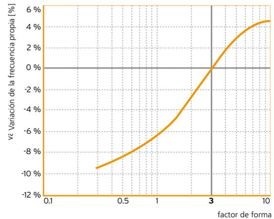
\*Valor de referencia: carga específica 0.0018N/mm², factor de forma =3
