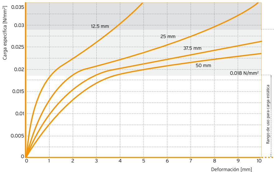
Figura 1: Curva de carga flecha cuasiestática a una velocidad de ensayo de 0.0018 N/mm<sup>2</sup>/s
