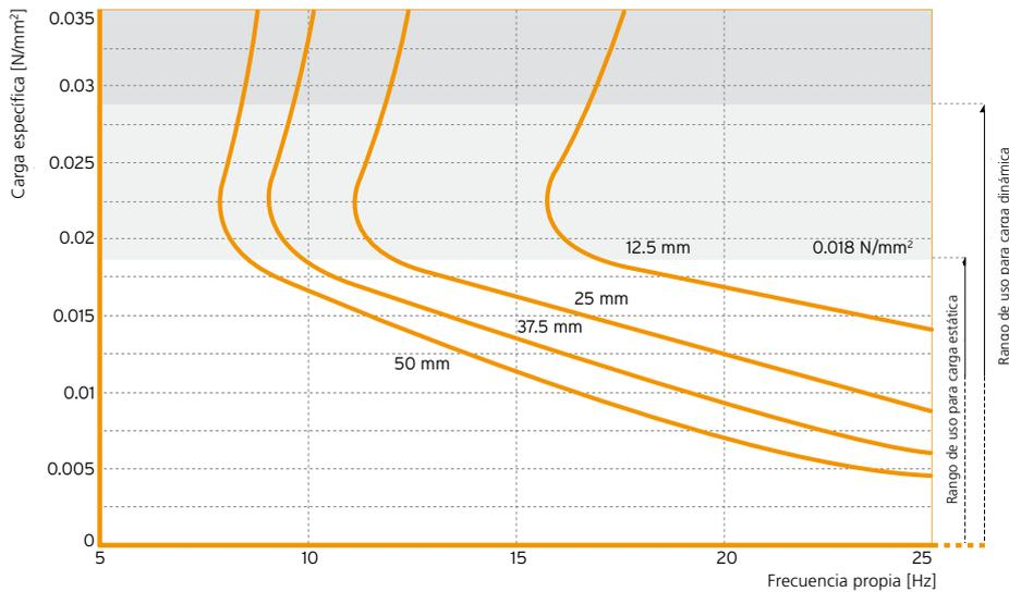
Figura 3: Frecuencia propia de un sistema simple de un grado de libertad que consiste en una masa fija conectada a un elemento elástico (Sylomer® SR 18) sobre un soporte rígido.
