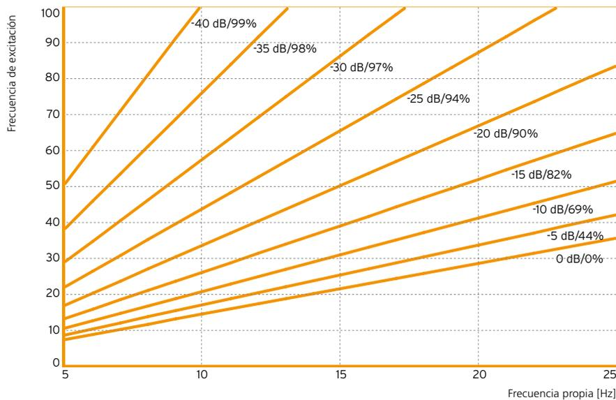
Figura 4: Reducción de la transmisión de las vibraciones mecánicas mediante la instalación del material elástico Sylomer® SR 18.
