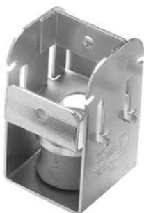
Gama diseñada para la suspensión de falsos techos acústicos y maquinaria trabajando a partir de 1.000 r.p.m. En toda la gama Akustik se mantiene el mismo elemento antivibratorio fabricado en caucho de gran calidad mecánica, especialmente diseñado para el aislamiento vibratorio. La estructura metálica es resistente a más de 650 kg y recubierta de baño electrolítico bicromatado.
